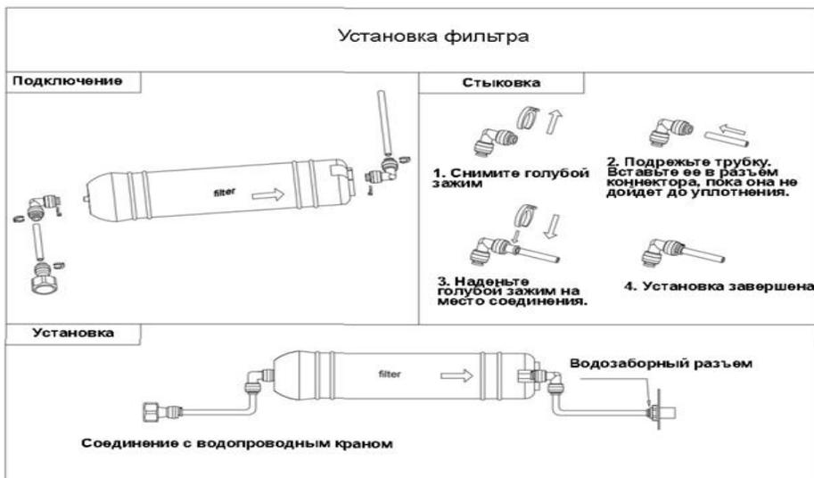
Рис.1 Схема подключению к водоснабжению.
