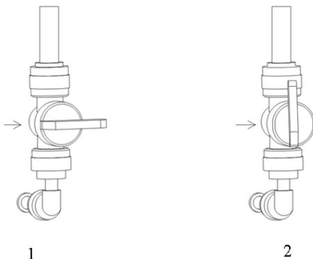
Кран подачи (выбор источника подачи воды) 1 положение закрыт. 2 положение открыт.
